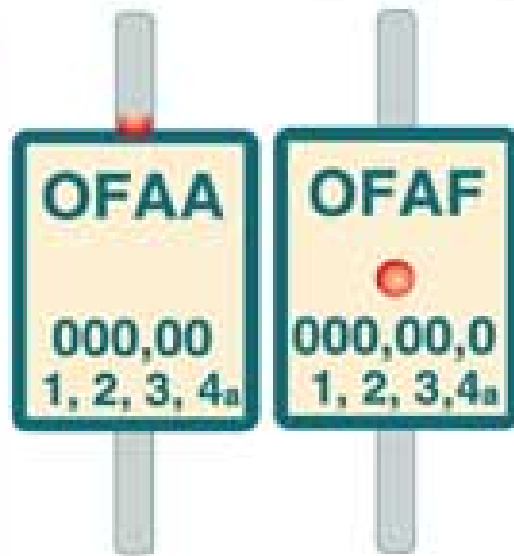
Индикатор расплавившейся вставки FuseLine
